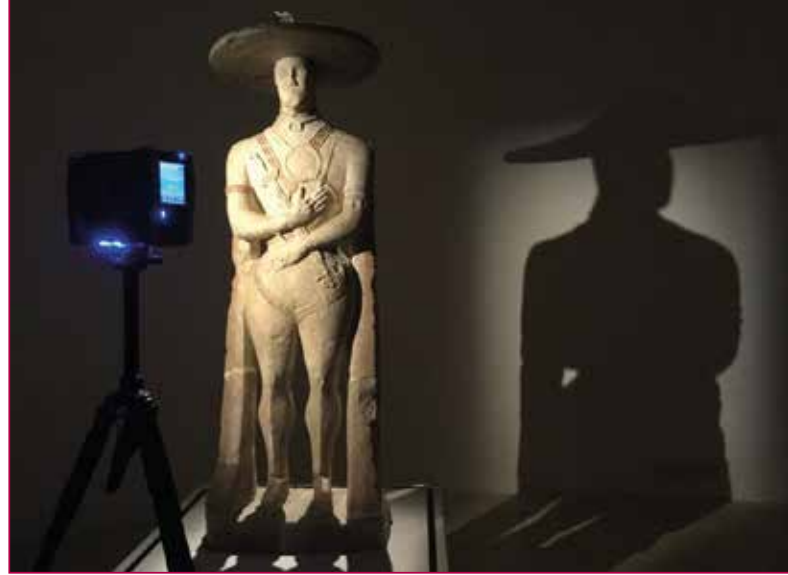
Fig. 2 - Fasi del rilievo Laser Scanner del Guerriero di Capestrano.
