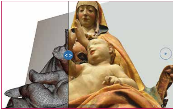
Fig. 4 - Sovrapposizione di mesh e texture sul modello 3D della Madonna di Collemaggio.
