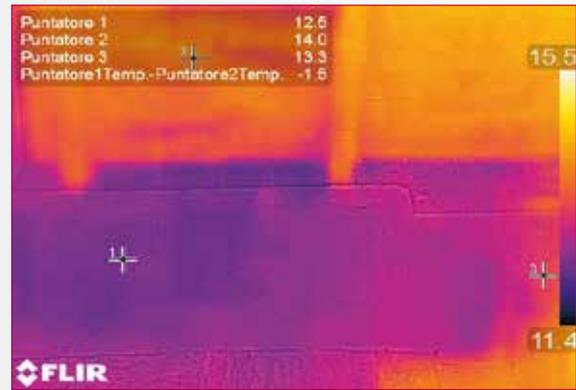
Figg. 6-7 - Carinola (CE), Palazzo Marzano. Termogrammi ottenuti dai rilievi condotti nella fase di analisi pre restauro. Si evidenziano i punti di rilievo (Sp), nonché la scala termica di riferimento in falsi colori.
