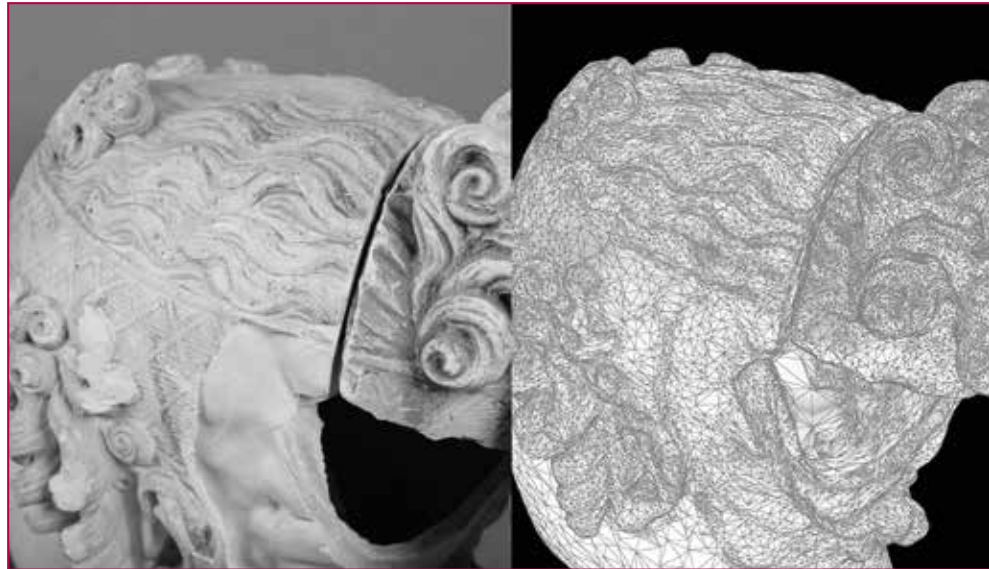
Fig. 5 - Allineamento e ricostruzione digitali dei frammenti con Rhinoceros a confronto con l'allineamento dei frammenti originali.
