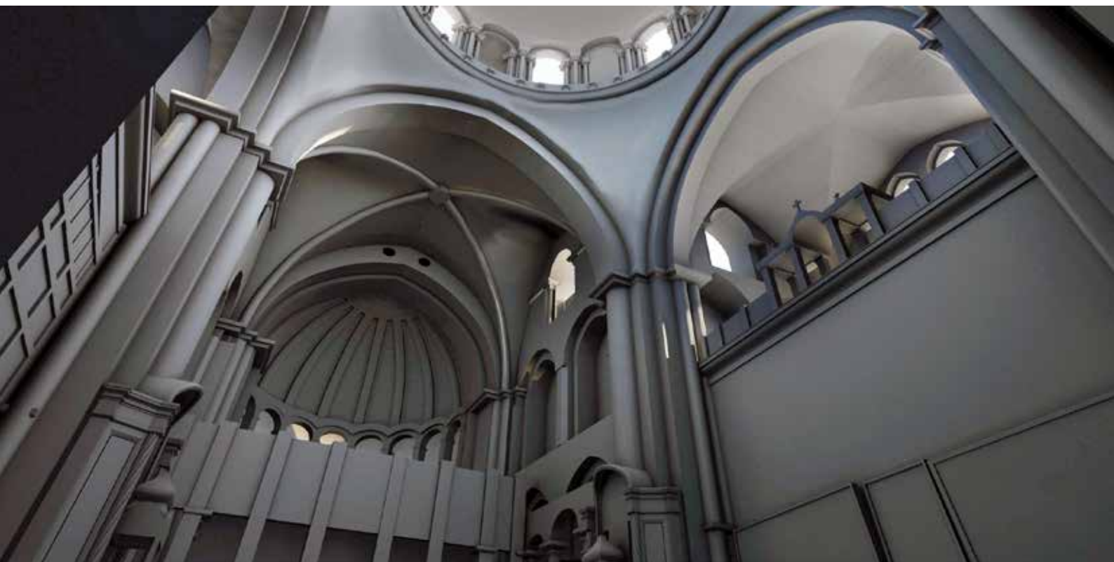
Fig. 7 - Una vista renderizzata del modello 3D del sistema voltato dell'abside e della volta sopra il Katholicon. E' stata data priorità alla modellazione degli elementi strutturali mentre le parti decorative sono volutamente trascurate. (Elaborazioni di Francesco Algostino).
