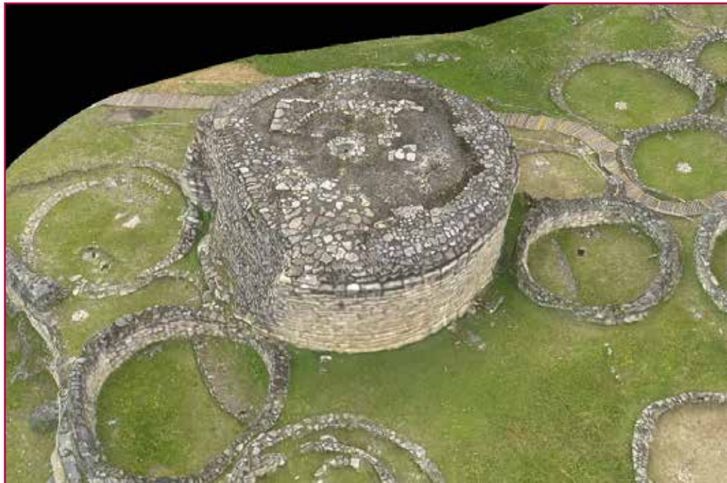
Fig. 6 - Rappresentazione della mesh texturizzata generata a partire dalla nuvola di punti LiDAR dell'edificio noto come Tintero (parte meridionale del sito).
