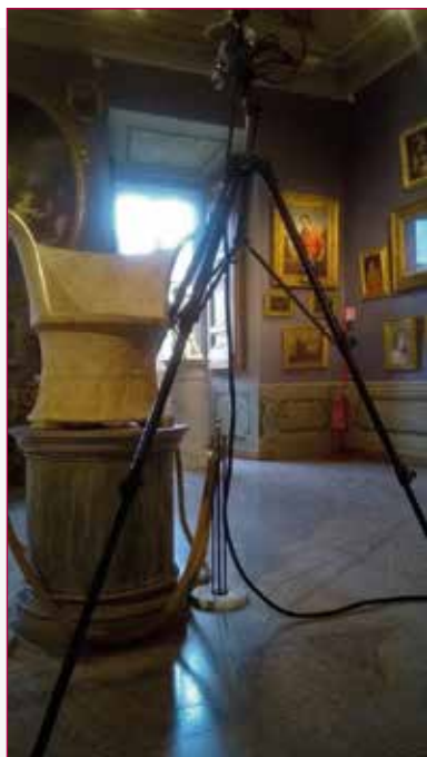
Fig. 7- Un momento della scansione a luce strutturata del Trono Corsini alle Gallerie Corsini-Barberini.
