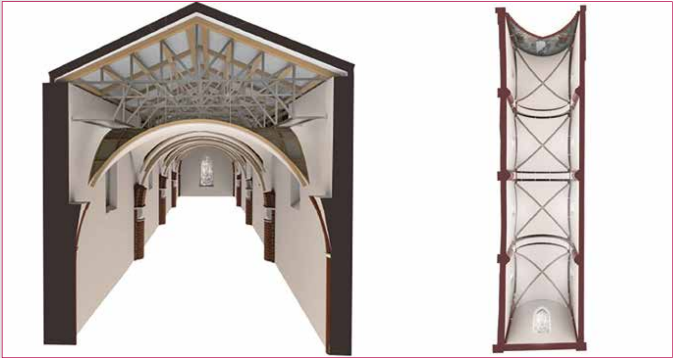
Fig. 2 - Render 3D della copertura della Navata Centrale.
