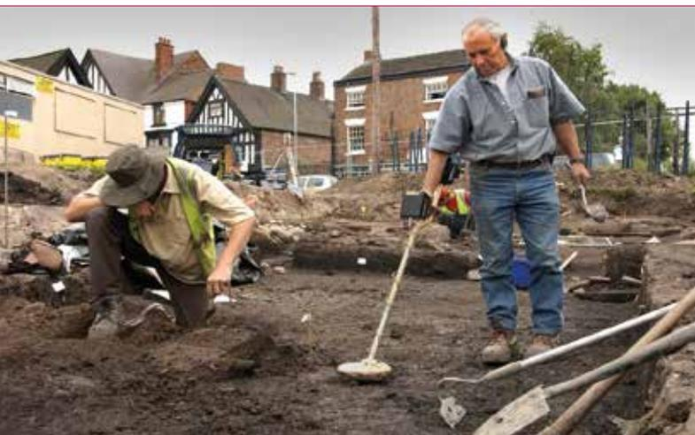
Il “metal detector” (in italiano, cercametalli) è uno strumento che utilizza alcune proprietà elettromagnetiche dei metalli per rilevare la presenza di oggetti metallici sepolti nel terreno.
