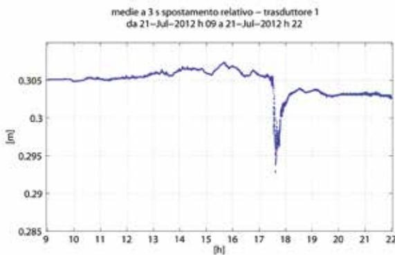
Fig. 6 - Valori di posizione relativa mediati su finestre di 3 secondi, per il trasduttore di spostamento in direzione N/NE.
