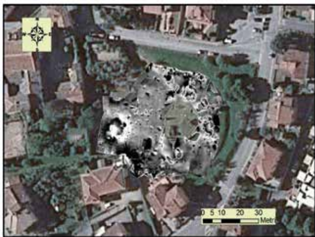
Fig. 3 - Mappa magnetometrica ottenuta con il magnetometro FEREX.
