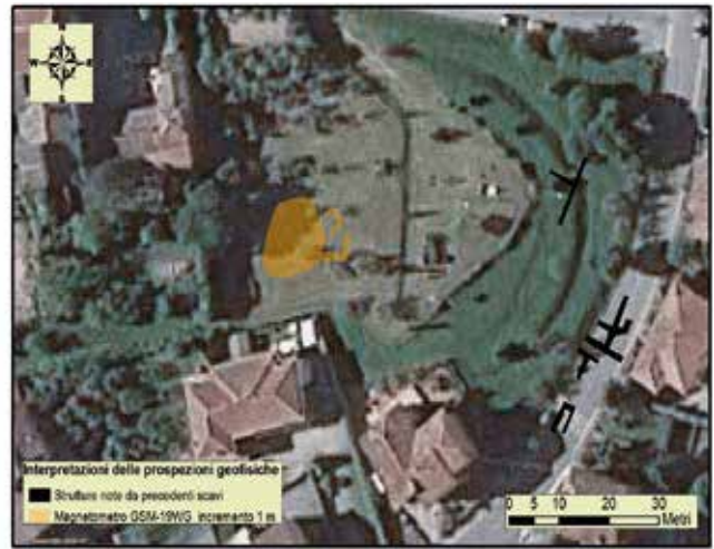
Fig. 8 - Rapporto tra le anomalie individuate con il GSM-WG19 e le strutture note dai precedenti scavi.
