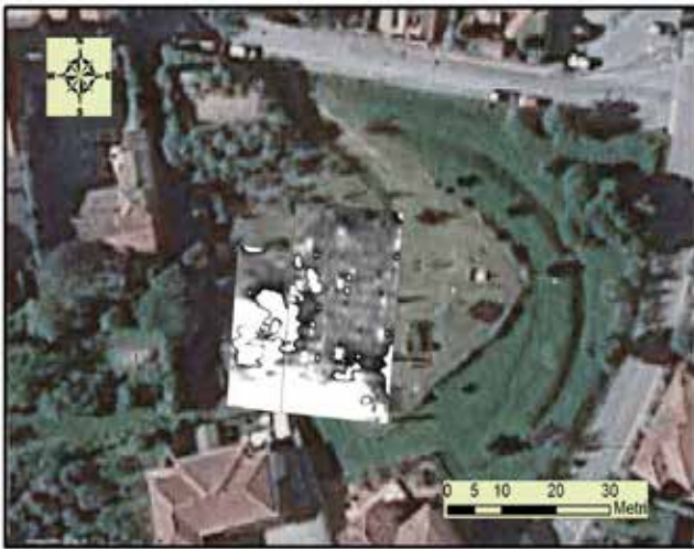
Fig.6 - Mappa magnetometrica ottenuta con il magnetometro GSM-WG19.
