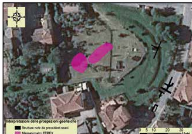
Fig. 5 - Rapporto tra le anomalie individuate con il FEREX e le strutture note dai precedenti scavi.
