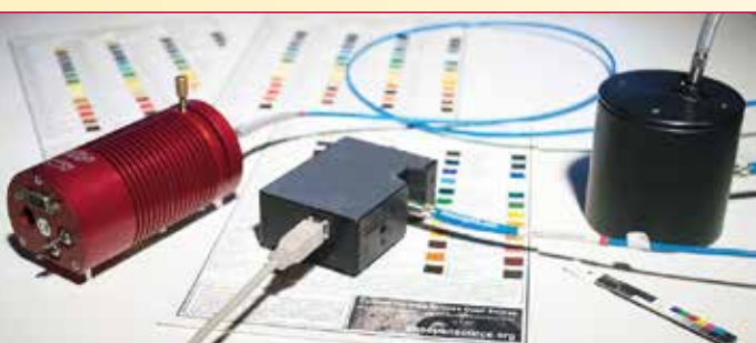
Fig. 1 - Sistema FORS, Fiber Optics Reflectance Spectroscopy, sviluppato dalla GHT Photonics srl con componenti Ocean Optics: da sinistra a destra, lampada ad incandescenza, spettrometro modello USB4000 e sfera integratrice.
