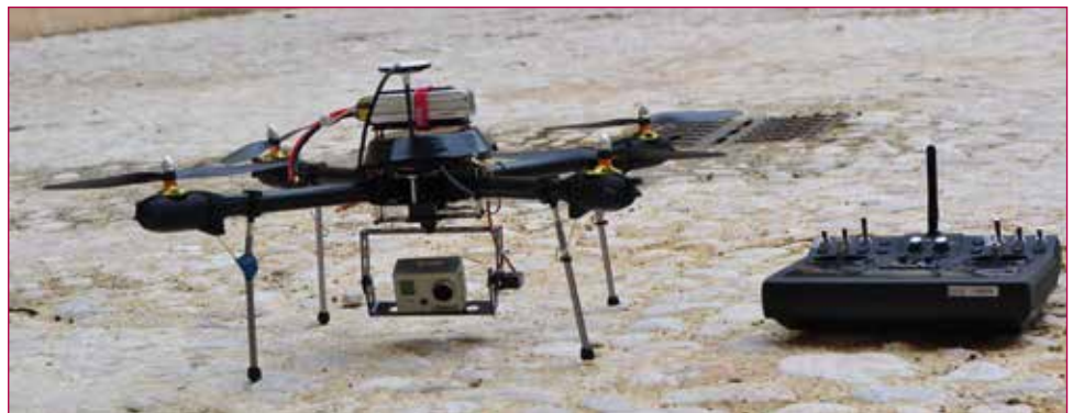
Fig. 2 - Quadricottero elettrico con radiocomando e telecamera a bordo utilizzato per le riprese.
