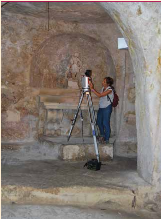
L'antichità incontra l'alta tecnologia, ricercatrice dell'Istituto per le tecnologie della costruzione (ITC-CNR) in attività di rilievo architettonico tridimensionale mediante scansione laser nella chiesa rupestre di San Michele delle grotte in Gravina di Puglia (BA). Foto di Salvatore Capotorto, ITC-CNR, Bari.
