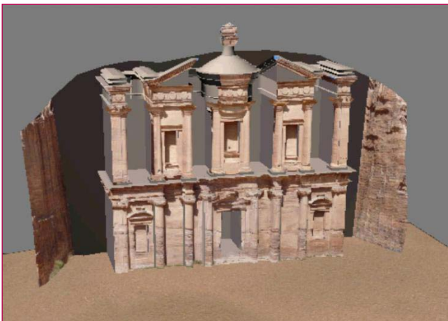
Ad Deir. Il modello finale con la texture costituita dalla proiezione del panorama centrale. Sono molto numerose le occlusioni (E. D'Annibale).
