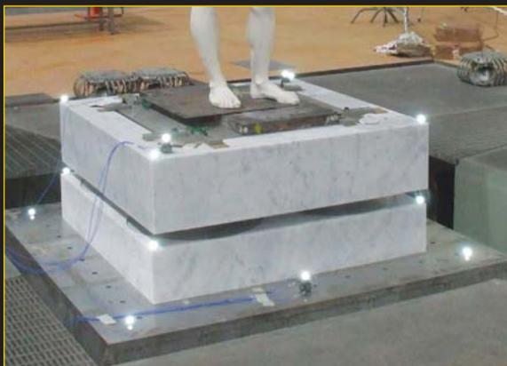
Figura 3b - Acquisizione dei dati di spostamento tramite sistema 3D\_Vision.
