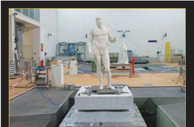
Figura 3a - Basamento posizionato sulla tavola vibrante per le prove sismiche.
