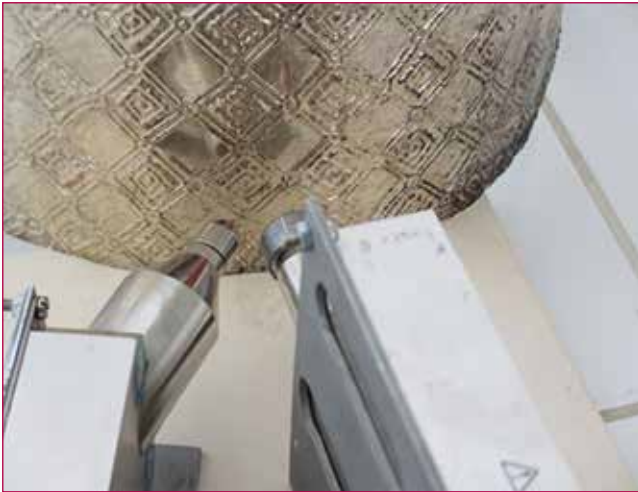
Fig. 2 - Strumentazione utilizzata per l'analisi di fluorescenza X.
