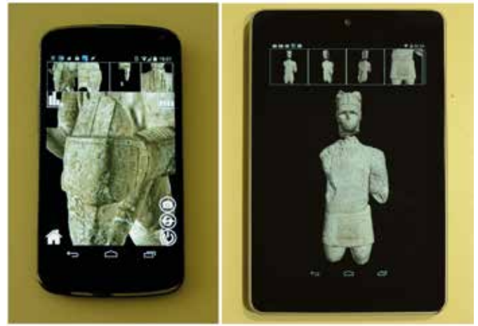
Fig. 6 - Esplorazione interattiva dei modelli digitali su dispositivi mobili: un'interfaccia semplificata (Balsa, 2014) ed un'architettura client-server (Balsa, 2013) consentono di visualizzare i modelli digitali ad alta risoluzione su smartphone e tablet di nuova generazione.
