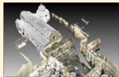
Fig. 2 - Rilievo Laser Scanner: fasi della fusione delle nuvole di punti all'interno del software SCENE.
