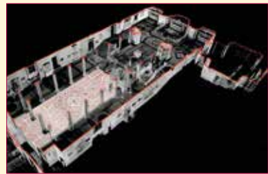
Fig. 3 - Rilievo Laser Scanner: Spaccato prospettico della Cattedrale con in evidenza lo splendido pavimento musivo bizantino medievale.
